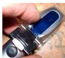
Après la mise au point suivant le mode d'emploi du réfractomètre, la lecture de l'humidité du miel est déterminée à la limite de la zone sombre et de la zone claire. Ici le miel a 16 % d'eau. Plus le miel est sec plus la partie vert sombre diminue, plus le miel contient de l'eau plus la partie vert clair diminue
