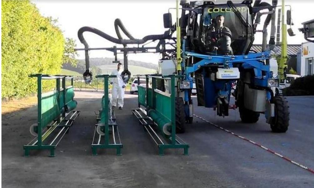
*Photo n° 22 : banc Evasprayviti en configuration REF*
