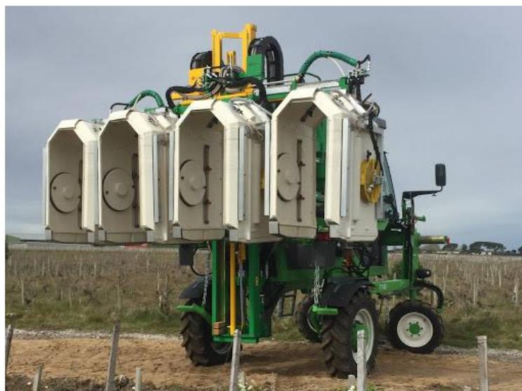
*Photo n° 23 : panneaux récupérateurs 4 rangs monté sur enjambeur*
